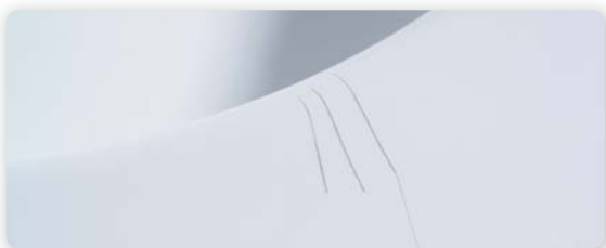
Damaged Acrylate | Beschädigtes Acryl
